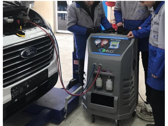
Klima gaz dolumu
